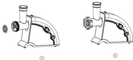
◆ Натисніть на кнопку фіксації і вставте горловину в отвір корпусу мотора. Вставте і повертайте проти годинникової стрілки, поки запобіжний фіксатор не почує місці.
