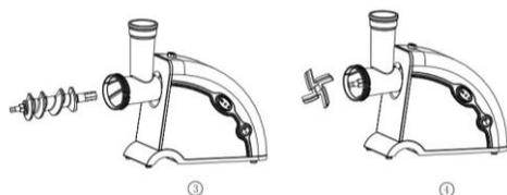
◆ Встановіть необхідний дисковий ніж на шнек, впритул до плоскої сторони ріжучого ножа. Переконайтесь, що дисковий ніж коректно встановлений в завантажувальну горловину (Мал. 5).
