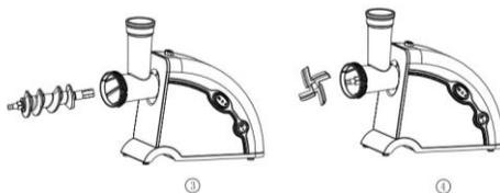
♦ Установите необходимый дисковый нож на шнек, вплотную к плоской стороне режущего ножа. Убедитесь, что дисковый нож корректно установлен в загрузочной горловине (рис. 5).
