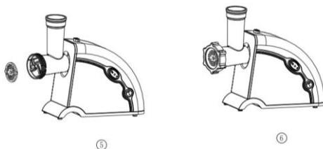
♦ Нажмите на кнопку фиксации и вставьте горловину в отверстие корпуса мотора. Вставьте и поворачивайте против часовой
